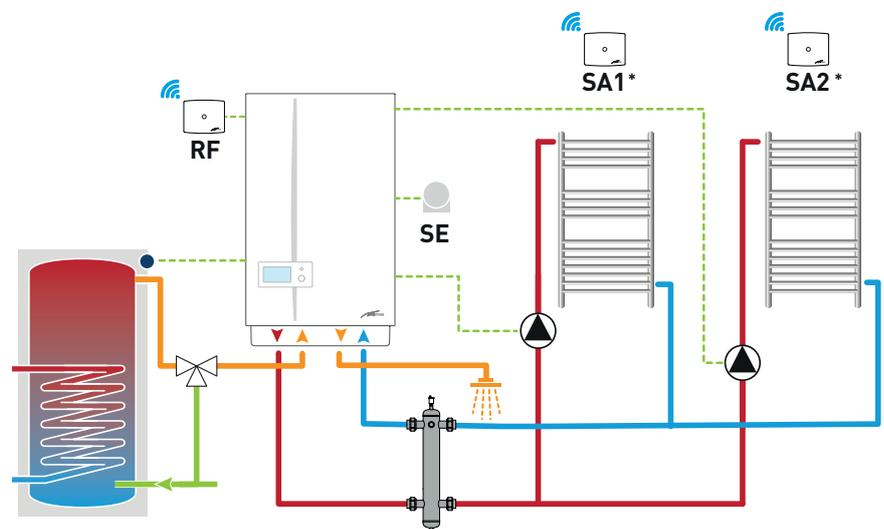
\* Sonde ambiente senza fili (SA1 - SA2) e ricevitore in radiofrequenza (RF) consentono la gestione completa delle zone e della caldaia tramite App Sime Connect.
