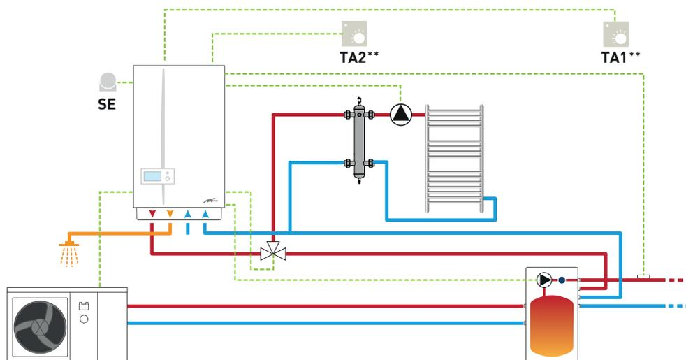
\* Sonde ambiente senza fili (SA1 - SA2) e ricevitore in radiofrequenza (RF) consentono la gestione completa delle zone e della caldaia tramite App Sime Connect. In alternativa è possibile utilizzare classici termostati ambiente limitando il controllo da App alla sola caldaia.
